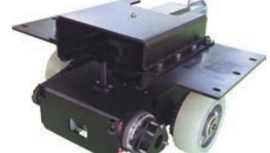
상하이동형 자유회전 차동구동 ( URDD : Up-down Free-rotating Differential drive )
