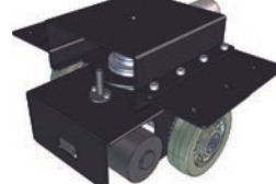
상하이동형 자유회전 차동구동 ( URDD : Up-down Free-rotating Differential drive )
